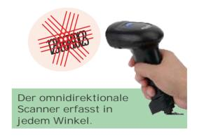
Der Abstand zwischen Scanner und Barcode muss so gewählt werden, dass alle Teile des Barcodes umfasst werden. Während des Scannens sollte das Gerät langsam zum Barcode hinbewegt werden. Bei Erkennungsproblemen den Scanner leicht kippen oder drehen.
